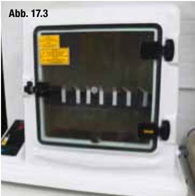
Klimaapparat Kondenswasserklima nach DIN EN ISO 6270-2.
