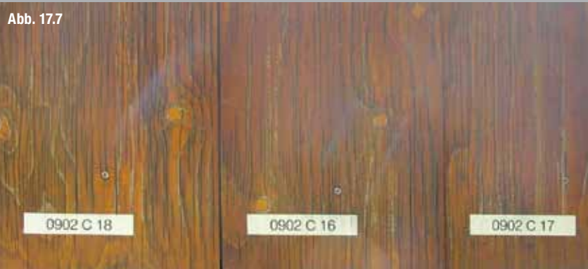
Wasserverdünnbare Systeme nach einem Jahr Bewitterung.
