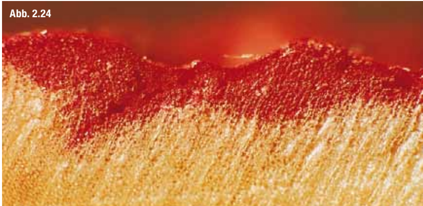
Durchtränkung und satte Umhüllung der Holzfasern durch Lackpartikel bei sägeraurem Untergrund
