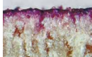
Simulation Penetrationsgefälle einer Imprägnierung auf Kiefernholz
