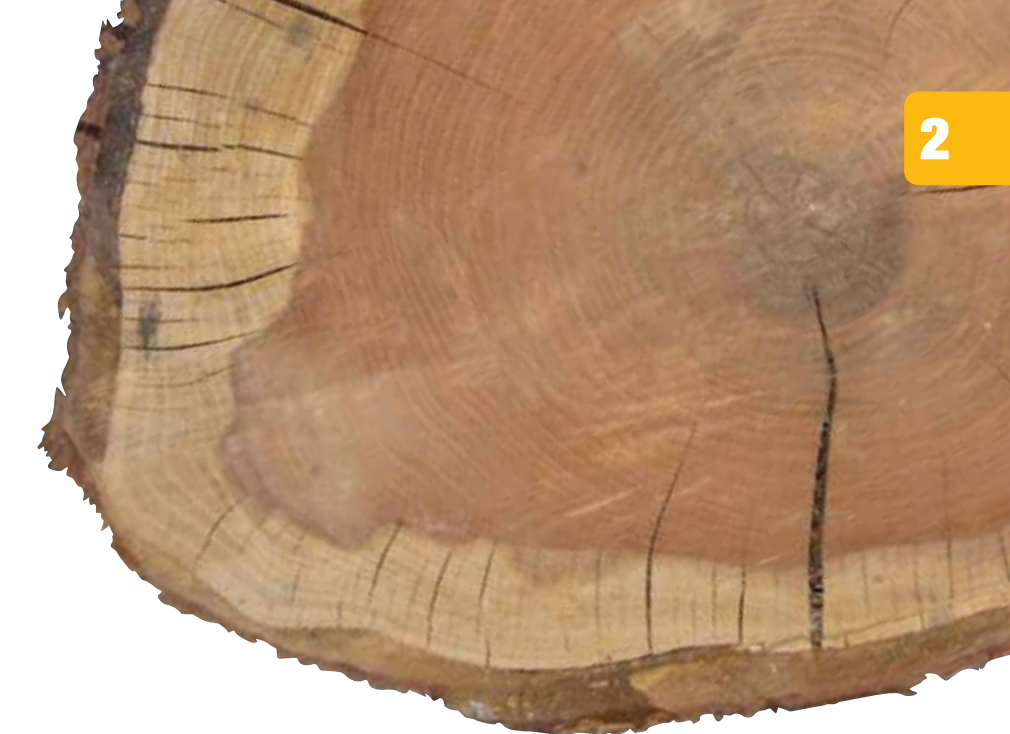
Abb. 2.10: Stammscheibe mit ausgeprägtem Kernholzanteil
