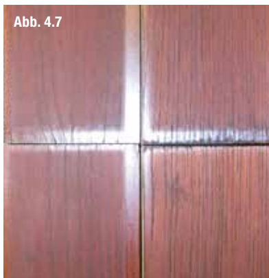
Testhölzer nach mehrwöchiger Klimabelastung analog EN 927-6
