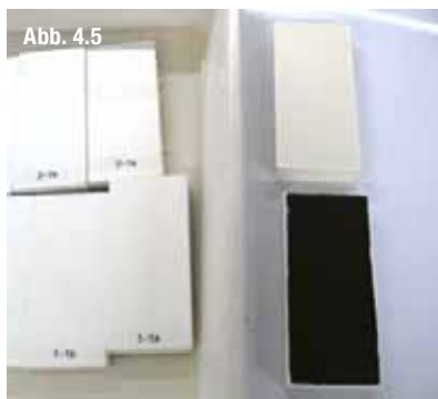
Abb. 4.5 Überprüfung der Wasseraufnahme nach EN 927-5
