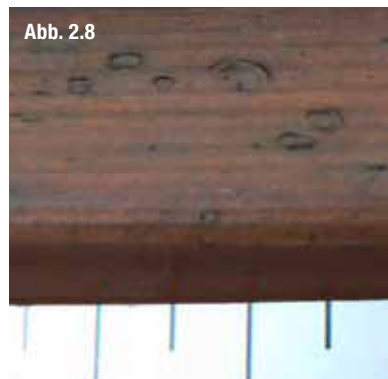
Von Bläuepilz befallene Oberfläche (infolge von Hagelschlag)
