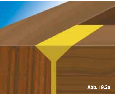
Nachverleimung von Eckverbindungen
