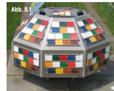
Abb. 8.1 Diamantförmiges Oktagon – ein Modell, um Bewitterungstests in Anlehnung an EN 927-3 zu perfektionieren (s. Seite 25), Standort Sassenheim, Niederlande
