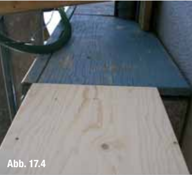
Keine zwei Jahre hat dieses deckend beschichtete Fassadenelement (Vergleich mit einer neuen Platte) einer starken Wetterexposition standgehalten.
