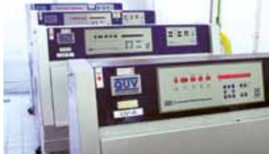
Laborraum mit künstlichen Bewitterungsapparaturen analog EN 927-6
