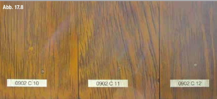
Lösemittelhaltige Systeme nach einem Jahr Bewitterung.
