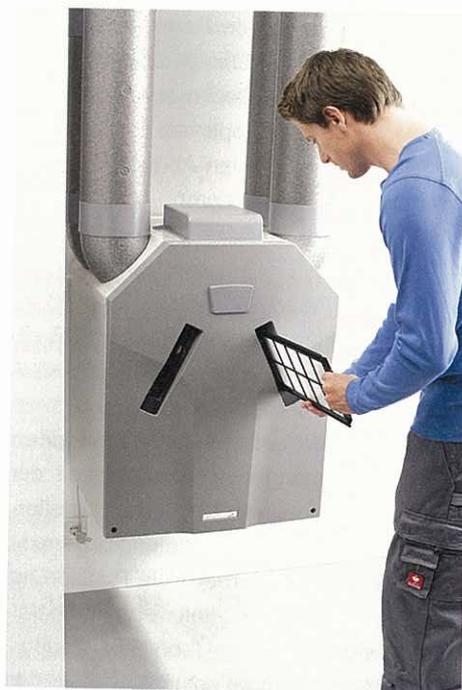
Für optimale Hygiene sollten Lüftungsanlagen alle zwei Jahre vom Fachmann gewartet werden. Die Reinigung des Gerätefilters kann der Kunde hingegen nach kurzer Einweisung ganz einfach und schnell selbst durchführen. Dies sollte er alle drei bis sechs Monate beherzigen
